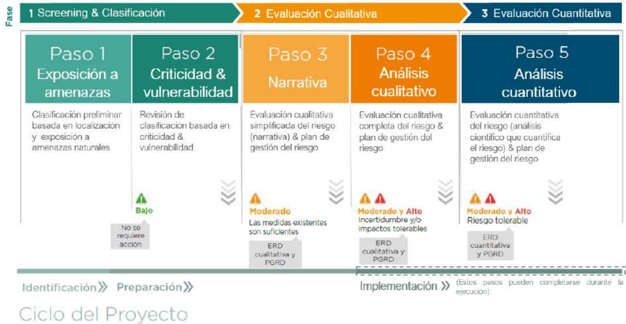
Imagen No. 115. Metodología de Evaluación del Riesgo de Desastres y Cambio Climático del BID. Fuente: Metodología para la Evaluación del Riesgo de Desastre y Cambio Climático (BID, 2019).
