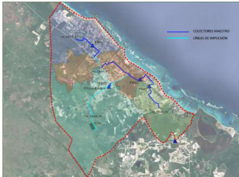
Imagen No. 15. Sistema proyectado para Friusa-Bávaro Fuente.: (Equipo de Consultores Externos del Banco Interamericano de Desarrollo, 2025)
