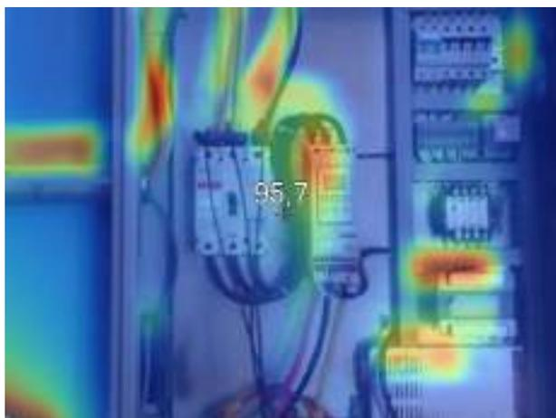
La imagen muestra un panel de control con varios componentes, incluyendo lo que parece ser un arrancador o un contactor principal (el componente grande a la izquierda con el display). La lectura de 95.7°F está en la parte central de este componente. Hay otras zonas cálidas (rojo/naranja) en el panel, indicando componentes energizados.
