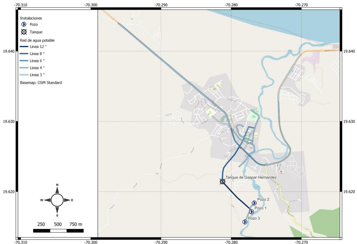
Ilustración 3 - Esquema general de tuberías primarias de agua potable de Gaspar Hernández
