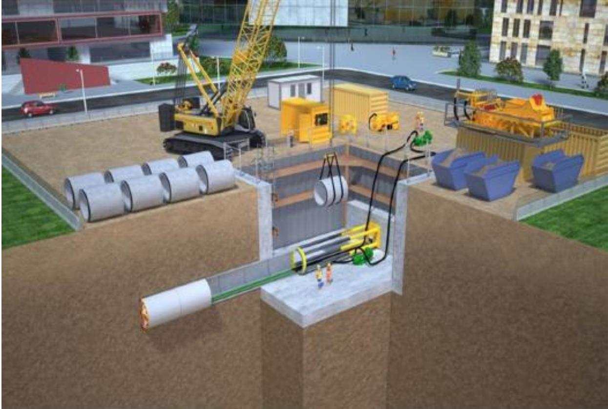
**Figura 2 Microtunelación**
