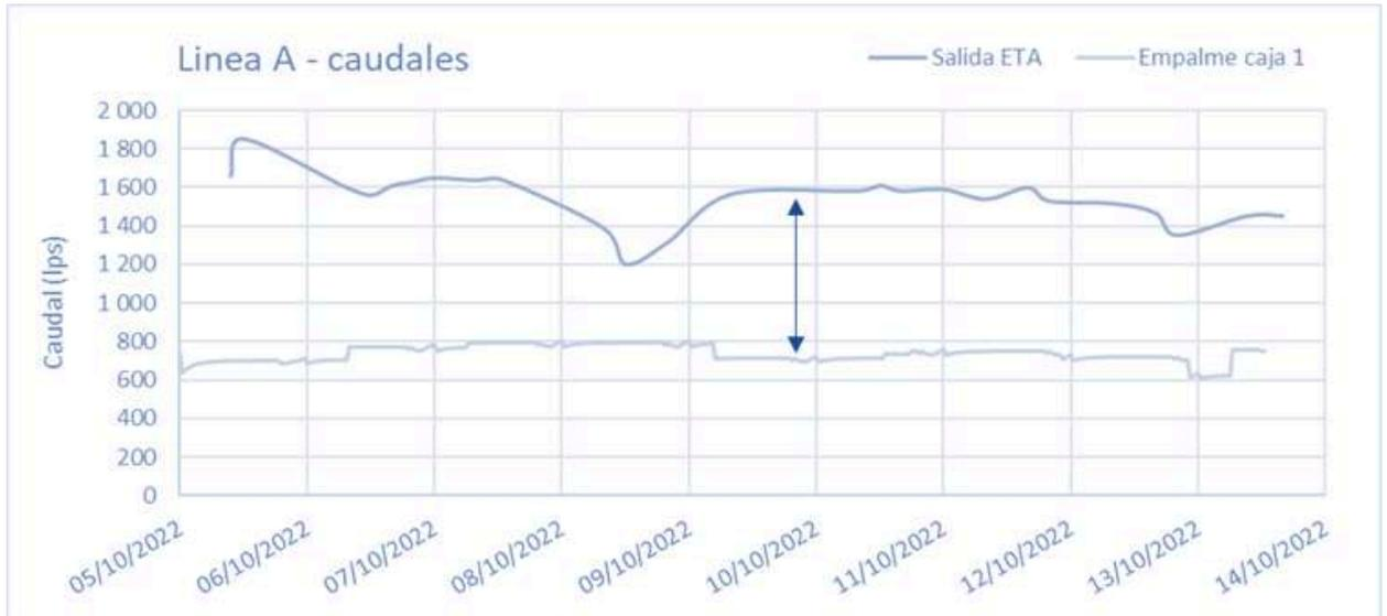
*Mediciones de caudal en la línea A (Fuente: resultados de las mediciones realizadas por SEURECA en el marco del diagnóstico detallado de la AT - dic. 2022)*
