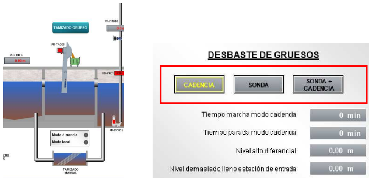
Figura 9. Desbaste de gruesos – vistas del SCADA y parámetros
