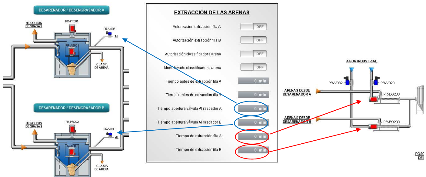
Figura 18. Extracción de arena – vistas del SCADA y parámetros
