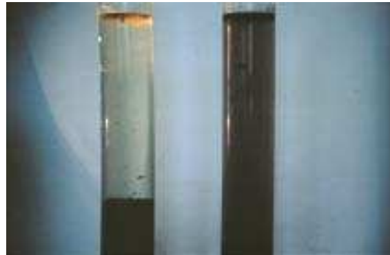
Figure 5 – Tests en éprouvettes – présence de flottants
