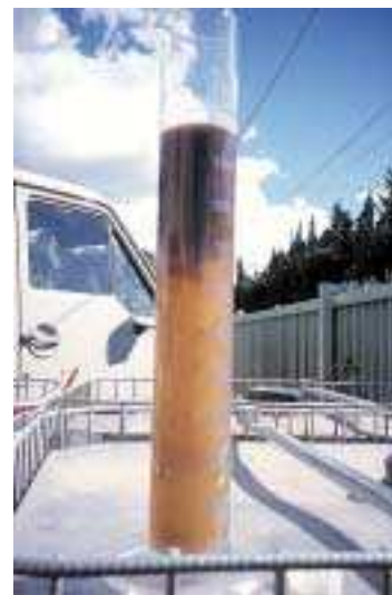
Figure 10 – Test en éprouvette – Remontée de boue
