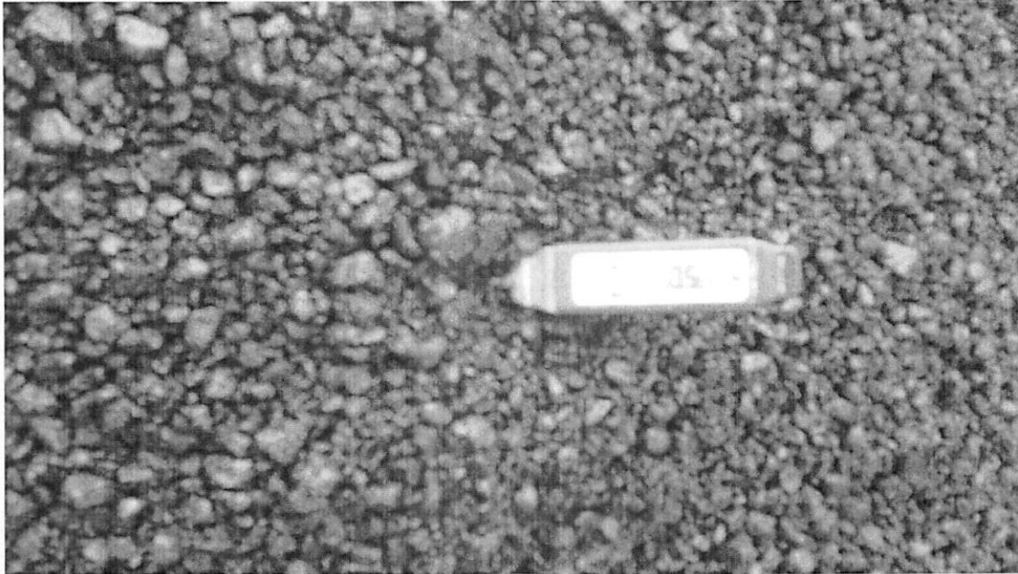
Ilustración 1: Toma de Temperatura en Asfalto Caliente
