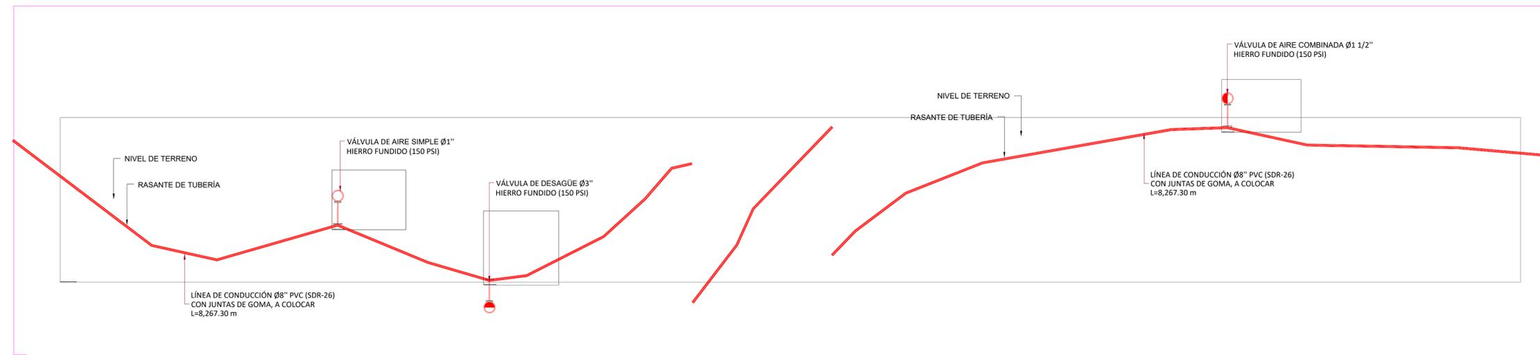
PERFIL LÍNEA DE CONDUCCIÓN Ø8" PVC (SDR-26) CON JUNTAS DE GOMA (EST. 3+948 - 4+606)
