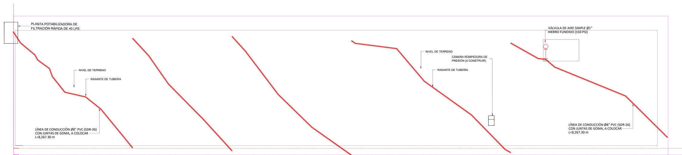
PERFIL LÍNEA DE CONDUCCIÓN Ø8" PVC (SDR-26) CON JUNTAS DE GOMA (EST. 0+000 - 0+658)
