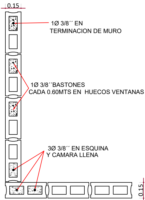
BASTONES EN MUROS
